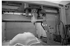
[그림 14] CNC 밀링머신을 이용한 contouring 작업
